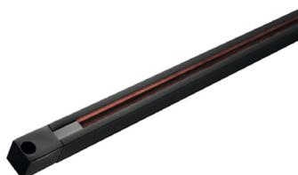
Particulièrement fin, ce support rail alimenté en 24V permet de positionner et d'alimenter sur toute sa longueur les différents spots de la Gamme Slim par simple contact bille. Grâce à une conception totalement innovante, en option, le rail Slim permet de contrôler et de commander individuellement, via un protocole Dali, chaque source lumineuse. Pratique et évolutive, cette solution rail se compose à la carte, pour un éclairage discret et totalement modulable.
