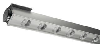
La Line 021 est un linéaire composé de LED de puissance, équipées chacune de lentilles et placées les unes après les autres. La lumière émise permet un éclairage rasant et homogène sur l'ensemble de la surface éclairée. Intégrée dans un profilé d'aluminium fixe, orientable ou en suspension de 36x37 mm, la Line 021 est disponible sur 6 longueurs possibles : 36 cm, 70 cm, 103 cm, 136 cm, 170 cm & 203 cm. Plusieurs modèles sont proposés en fonction des caractéristiques souhaitées.
