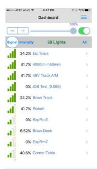
Lorsque l'application XIMtroller est ouverte, l'écran "Dashboard" apparaît. Il va alors s'afficher l'ensemble des projecteurs en fonctionnement. Le processus d'inscription peut prendre plusieurs secondes, selon le nombre de projecteurs en fonctionnement et l'intensité du signal Bluetooth. Dans la partie supérieure grisée, s'affiche le nom de l'écran et le bouton Paramètres "Settings" dont l'icône ressemble à trois barres horizontales.
